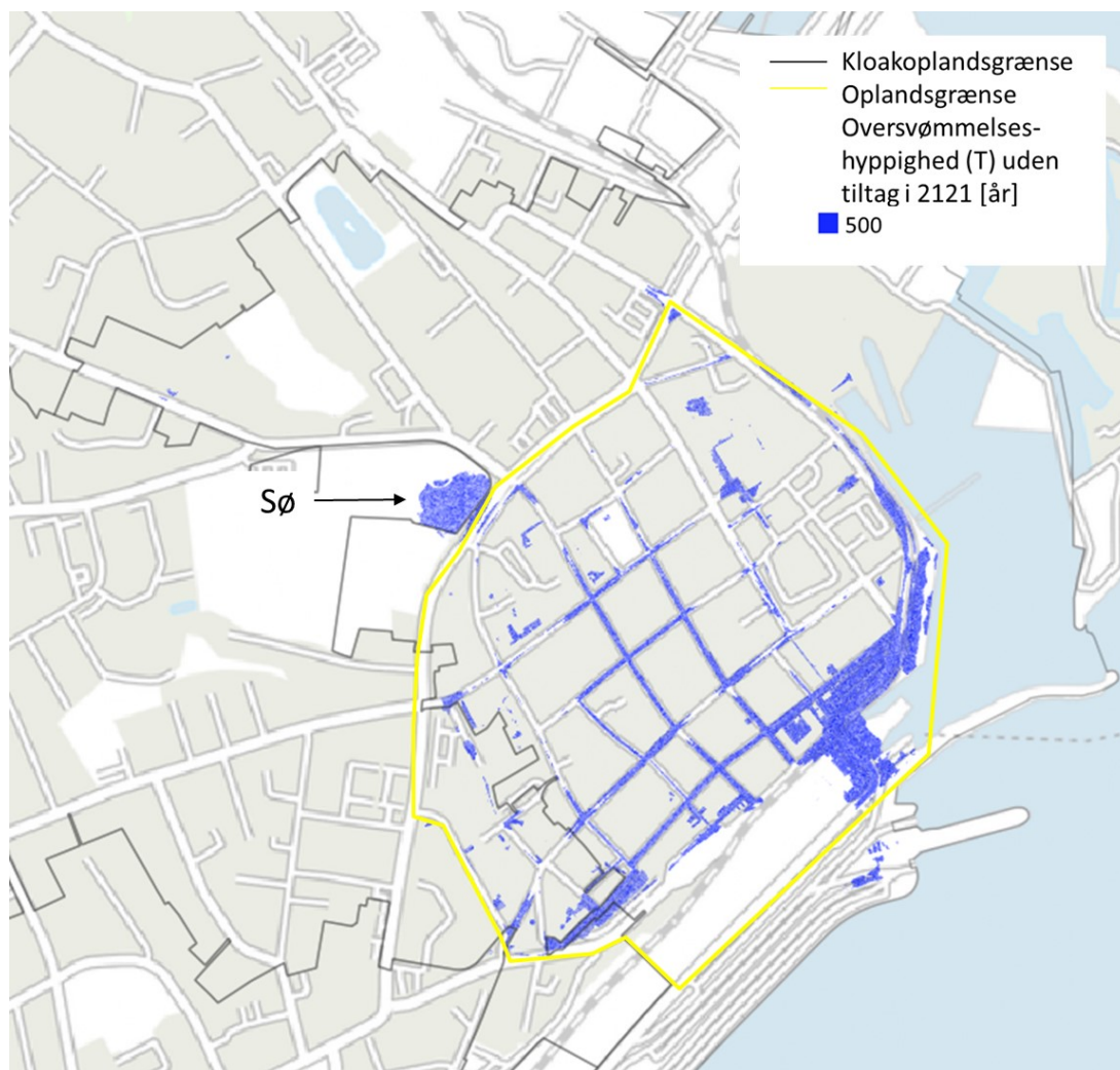
Figur 1: Kloakoplandsgrænsen, oplandsgrænsen og oversvømmelserne for en 500 års hændelse i 2121 i oplandet, hvis der ikke gennemføres tiltag.
